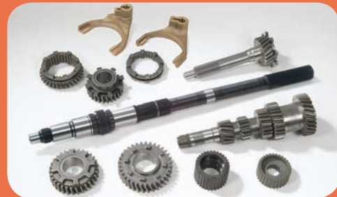
Anillo de retención (dog ring) helicoidal del modelo T-5, con eje en acero 9310 opcional, aprobado por el NMRA
